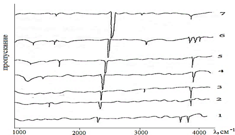
Рис.1. ИК-спектры пропускания компонентов системы ZnTe-CdS, хранившихся на воздухе: 1- ZnTe; 2-(ZnTe) 0,9 (CdS) 0,1 ; 3- (ZnTe) 0,75 (CdS) 0,25 ; 4- (ZnTe) 0,5 (CdS) 0,5 ; 5- (ZnTe) 0,25 (CdS) 0,75 ; 6 - (ZnTe) 0,1 (CdS) 0,9 ; 7 – CdS
