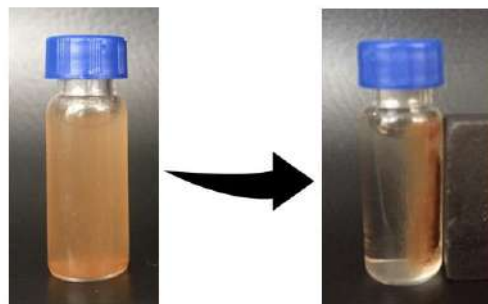
Рис. 5. Фотографии взаимодействия магнита с образцом Fe_3O_4@SiO_2@Mg/AlFe-СДГ
