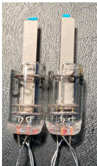
Рис.1. Образцы сенсоров на продольных колебаниях с фрагментами МОКС структуры бензолтрикарбоксилата меди Cu-BTC
