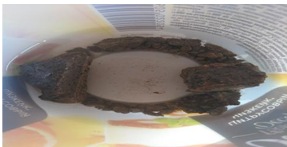
Рисунок 1б – Образцы бетона без пропитки в 4% растворе 3-х компонентной модели противогололедного реагента, при циклических испытаниях (14 циклов).
