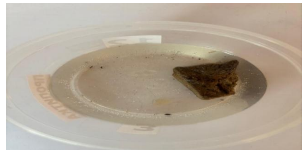
Рисунок 2г – Образцы бетона с пропиткой в 12% растворе 3-х компонентной модели противогололедного реагента, при циклических испытаниях (14 циклов).
