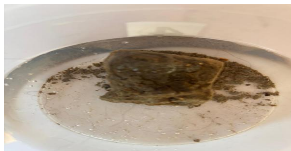
Рисунок 2.б – Образцы бетона с пропиткой в 4% растворе 3-х компонентной модели противогололедного реагента, при циклических испытаниях (14 циклов).
