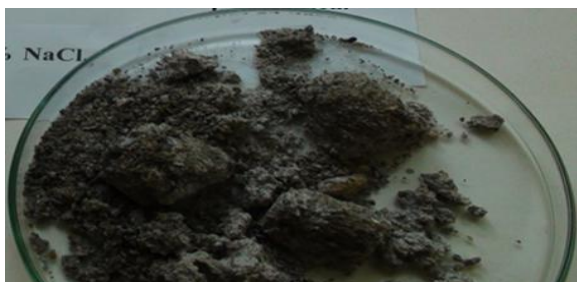
Рисунок 1а – Образцы бетона без пропитки в 2% растворе 3-х компонентной модели противогололедного реагента, при циклических испытаниях (14 циклов).
