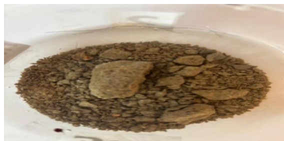
Рисунок 2а – Образцы бетона с пропиткой в 2% растворе 3-х компонентной модели противогололедного реагента, при циклических испытаниях (14 циклов).
