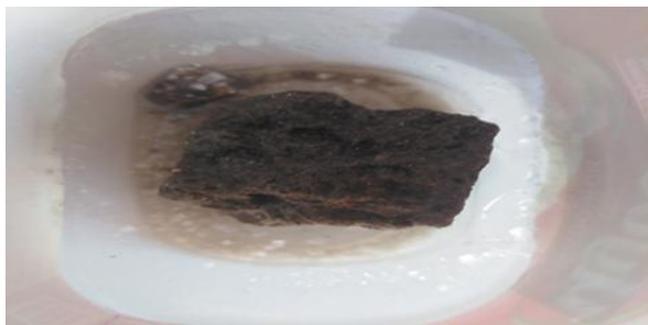
Рисунок 1г – Образцы бетона без пропитки в 12% растворе 3-компонентной модели противогололедного реагента, при циклических испытаниях (14 циклов).
