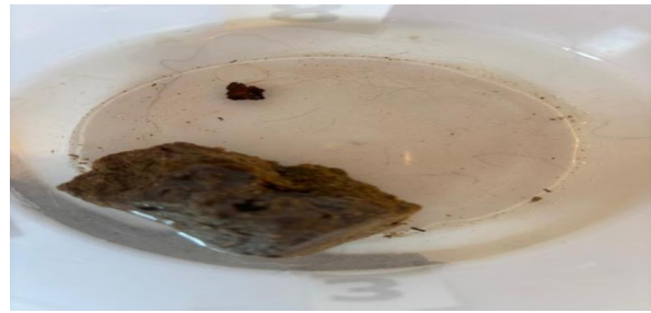
Рисунок 2в – Образцы бетона с пропиткой в 8% растворе 3-компонентной модели противогололедного реагента, при циклических испытаниях (14 циклов).
