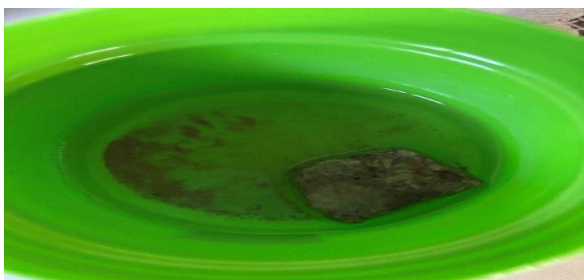
Рисунок 3а – Образцы бетона в дистиллированной воде, без пропитки, при циклических испытаниях (перепад температур с + на -, 25 циклов).
