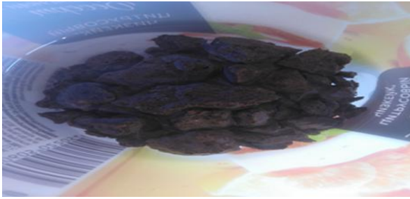
Рисунок 1в – Образцы бетона без пропитки в 8% растворе 3-компонентной модели противогололедного реагента, при циклических испытаниях (14 циклов).
