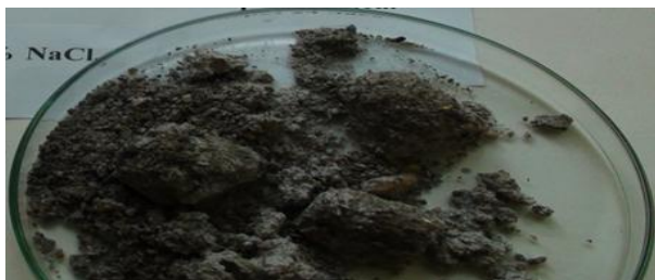
Рисунок 1.а – Образцы бетона в опыте 2% растворе 3-х компонентной модели противогололедного реагента, при циклических испытаниях (перепад температур с -12°С на +20°С, 25 циклов).
