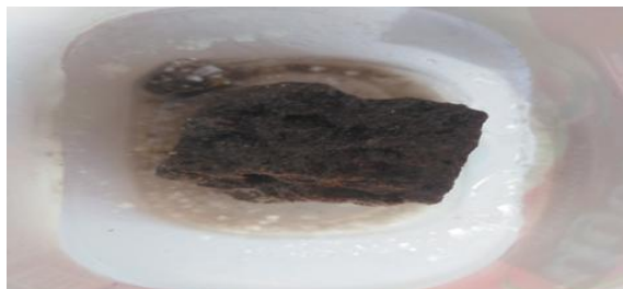
Рисунок 1.г – Образцы бетона в опыте 12% растворе 3-х компонентной модели противогололедного реагента, при циклических испытаниях (перепад температур с -12^{\circ}\text{C} на +20^{\circ}\text{C} , 25 циклов).
